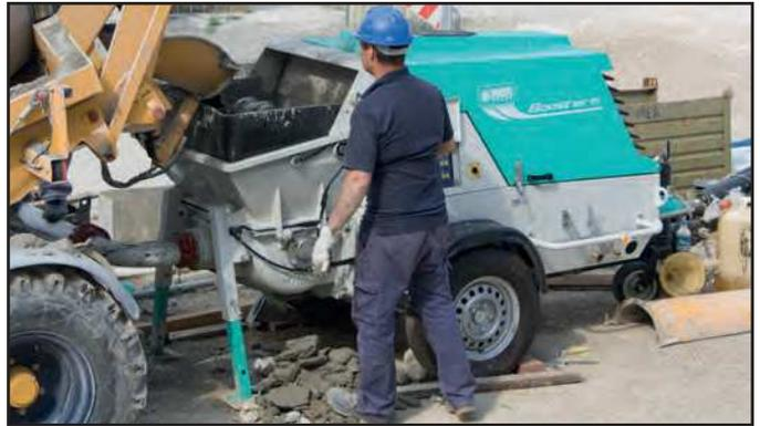
Alimentación para camión, hormigonera o autohormigonera
