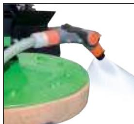
Provisto de un grifo con ajuste regulable y progresivo para el agua, que humedece directamente la pared por medio de un spray atomizador.
