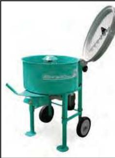
Están provistas de un final de carrera de seguridad. Cuando se abre la tapa con su rejilla rompesacos se para automáticamente la máquina y no se acciona de nuevo hasta que no se rearma con el interruptor.
