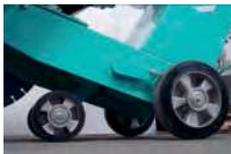
Con la máquina totalmente elevada, las pequeñas ruedas delanteras se aproximan a las ruedas traseras, por lo que se consigue una gran facilidad en sus maniobras. Con este sistema, se puede girar la máquina en cualquier sentido, con gran rapidez y con un mínimo esfuerzo personal.
