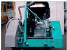
Con barra para la guía del corte, fijada sobre dos puntos al chasis de la máquina, lo que le permite una mayor estabilidad y como consecuencia, una mayor precisión en el corte.
