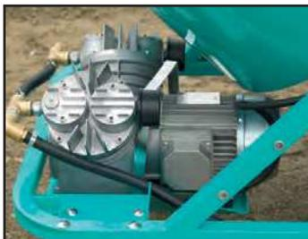
Compresor eléctrico de membranas (original IMER)
