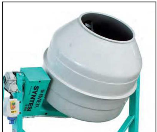
Al eliminar sobre las hormigoneras tradicionales los principales componentes mecánicos: corona de rotación de la cuba, piñón de ataque a la corona, patea motriz y carcasa de basculación con volante mediante registros, ésta ofrece la máxima seguridad para el operario y el mínimo mantenimiento. La ausencia de engranajes mecánicos externos, reduce su rumorosidad hasta 72 dB(A). Se ve girar la cuba pero no se la oye.
