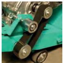
La transmisión es mediante sólo una única y ancha correa de tipo Poly - V. Esta característica es muy importante, porque al ser una única correa, su correcta tensión está garantizada, a diferencia de otras máquinas que montan varias correas de transmisión, siendo muy difícil realizar una tensión totalmente uniforme, ya que por el uso, unas pueden estar más desgastadas y estiradas que otras.
