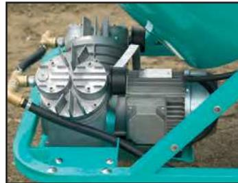
Compresor eléctrico de membranas (original IMER)
