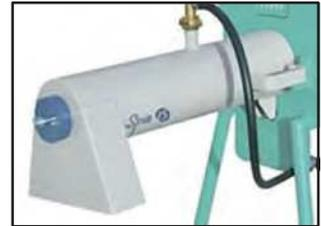
El SPIN-15 A ofrece una máxima seguridad al operario gracias a un sensor que paraliza automáticamente el giro de las palas, cuando su cámara de mezcla se abre, tal y como dictamina la Normativa CE.
