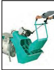
Pala/scráper con accionamiento hidráulico para carga cangilón
