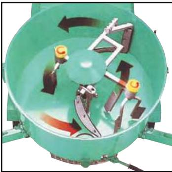
El sistema de mezclado permite una notable reducción del tiempo de mezcla del material. Por ejemplo, para la obtención de una mezcla de 200 l de mortero pobre con la MIX-360, equipada con motor trifásico son necesarios, aproximadamente, 25 segundos.
