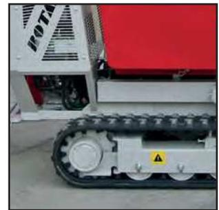
El tren de tracción con rodillos basculantes, asegura la estabilidad del mini transportador en condiciones de trabajo adversas, aumenta su eficiencia y proporciona una mayor duración de las orugas de goma, aumentando además la seguridad del operador.
