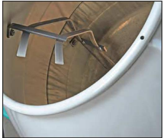
Al estar atornilladas las palas de amasado sobre la chapa de la cuba, éstas, con el desgaste se sustituyen de una forma mucho más fácil y rápida. Además, las palas atornilladas son mucho más duraderas que las soldadas, ya que éstas no han perdido resistencia con el calentamiento de la propia soldadura.
