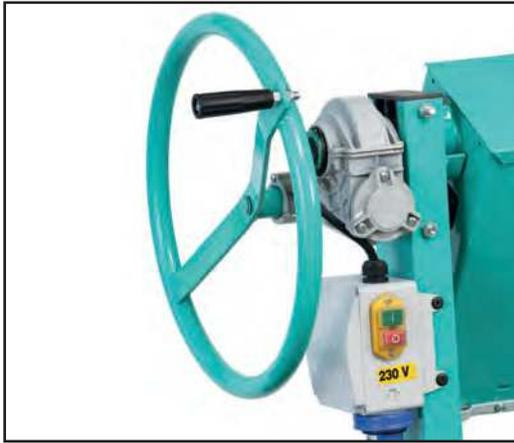
Gracias a su volante de tipo sinfin, reduce al máximo el esfuerzo personal del operario en su basculación, permitiendo a su vez este sistema posicionar la cuba de amasado con la inclinación exacta y precisa.
