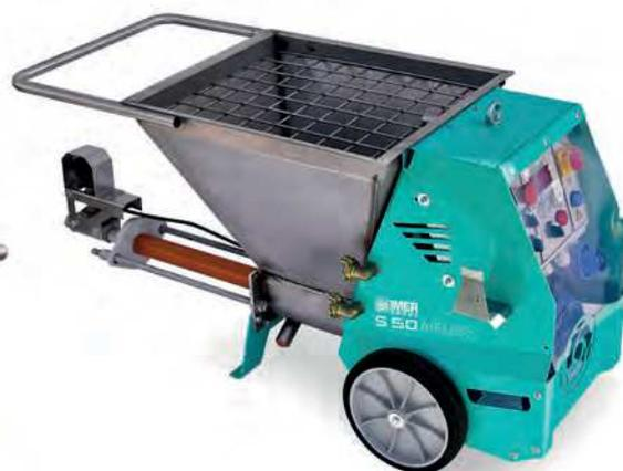
Su panel de control, sencillo e intuitivo, está equipado con el Exclusivo Inverter IMER, capaz de monitorizar continuamente la presión y de compensar automáticamente el desgaste de la camisa y las diferencias de fluidez entre unos materiales y otros, garantizando siempre una pulverización totalmente homogénea.
