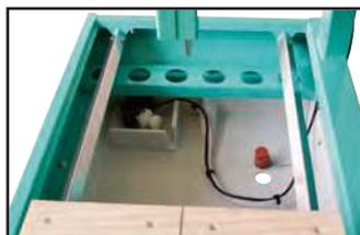
Con guías para el carro en acero inoxidable. Bomba de agua protegida para sedimentos. Higiénica cubete de plástico desmontable para su limpieza, con decantación para atrapar los sedimentos.
