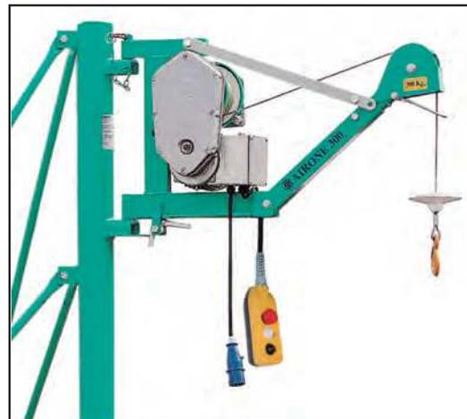
Equipado con un grupo moto-reductor, fabricado con engranajes de acero dentado heli-coidal inmersos en aceite. El dentado heli-coidal permite un funcionamiento muy silencioso y utilizando además el aceite como lubricante se obtiene una mayor protección y prolongación de la duración de la máquina. La lubricación con aceite permite, en igualdad de condiciones, una duración de los engranajes que duplica los engranajes lubricados por grasa.
