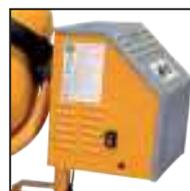
Cabina hermética metálica, muy robusta y resistente, con clavija e interruptor start/stop en una posición muy cómoda. (Modelo MIRAL-190).
