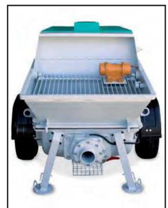
Tolla con agitador y rejilla con electrovibrador
